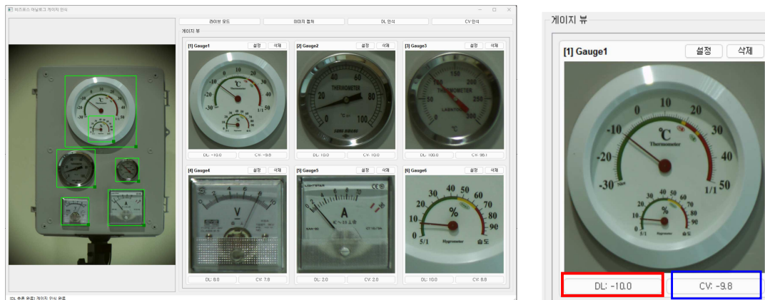
[6가지 종류의 게이지들에 대해 Open CV(CV) + AI 딥러닝(DL) 방법으로 전체를 인식한 모습]
