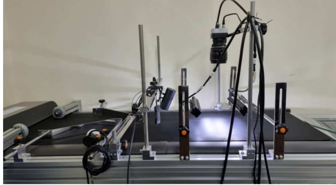
[컨베이어벨트에 카메라가 장착된 머신비전 시스템 실물(비즈포스 보유)]
