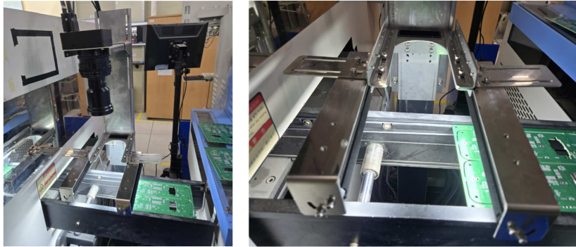
[SMT 공정에 머신비전 시스템을 설치한 모습 (SMT 제조기업에 설치)]
